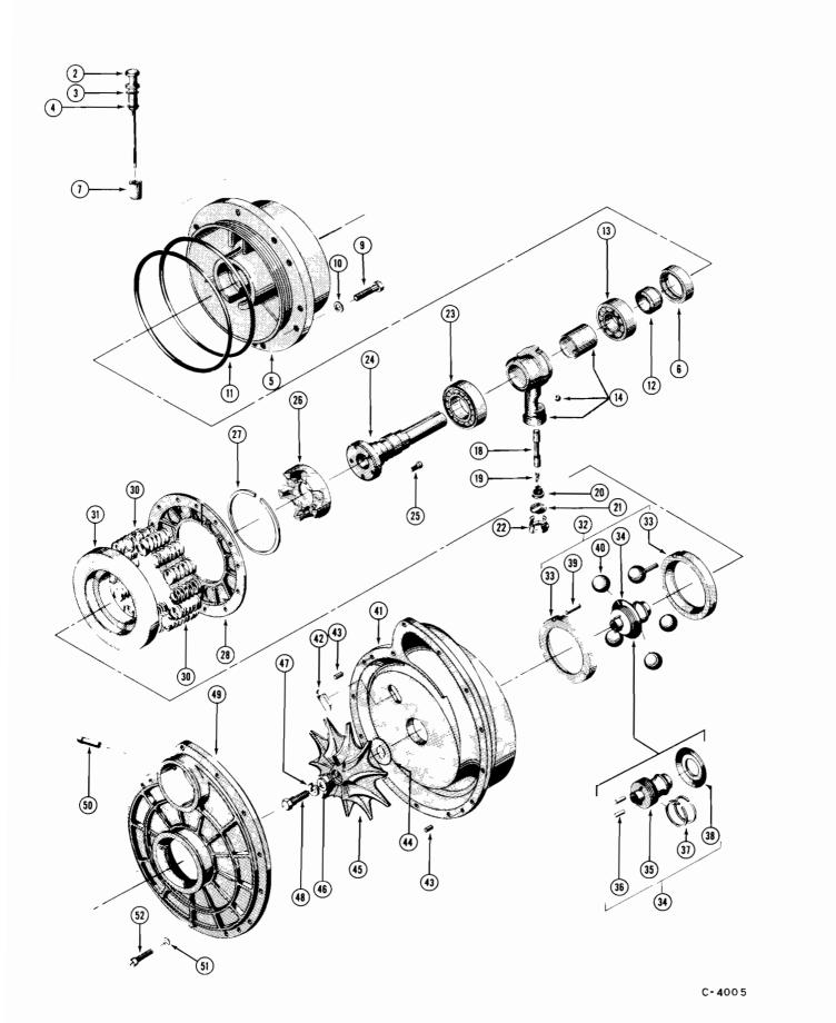
PARTS FOR SUPERCHARGER ASSEMBLY
